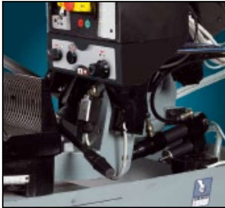
Hydraulic control system for automatic down feed. Sistema hidráulico de control de bajada automática.
